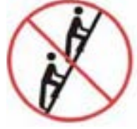
Pouze jedna osoba na výstupním rameni žebříku / příčkového žebříku
