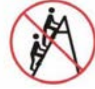
Pouze jedna osoba na výstupním rameni žebříku / příčkového žebříku
