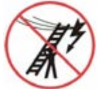
Uvědomit si nebezpečí elektrického vedení při přenášení žebříku
