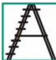
Zaistiť, aby bol zapojený poistný pásik proti nežiaducemu otvoreniu
