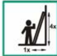
Vhodný úhel nastavení žebříku
