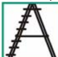
Zajistit, aby byl zapojen pojistný pásek proti nežádoucímu otevření
