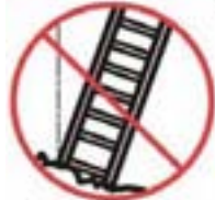
Postavení žebříku na vodorovném podkladu
