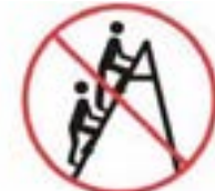
Iba jedna osoba na výstupnom ramene rebríka / priečkového rebríka
