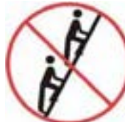
Iba jedna osoba na výstupnom ramene rebríka / priečkového rebríka
