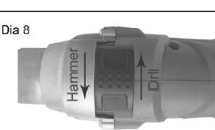
7) Vrtání/vrtání s příklepem (obr 8.)
