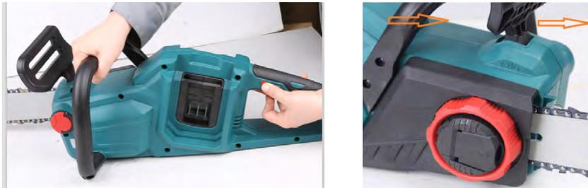
Funkcia istiaceho tlačidla spočíva v zamedzení náhodného stlačení hlavného prevádzkového spínača a následnému spustenie zariadenia. Pre spustenie zariadenia najskôr stlačte istiace tlačidlo a potom hlavný prevádzkový spínač. Pre vypnutie zariadenia hlavný prevádzkový spínač jednoducho opäť uvoľnite.
