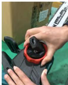
5. Otáčejte knoflíkem pro nastavení pnutí po směru hodinových ručiček a zkontrolujte napnutí řetězu. Otáčejte knoflíkem dál, dokud nedocílíte požadovaného napnutí. Pro kontrolu správného nastavení napnutí řetězu zatáhněte za pilový řetěz silou přibližně 1kg. Napnutí řetězu je nastaveno správně, pokud se mezi pilovým řetězem a vodící lištou objeví mezera o velikosti 5-7mm (viz níže).
