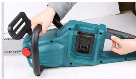
Funkce jistícího tlačítka spočívá v zamezení náhodného stisknutí hlavního provozního spínače a následnému spuštění zařízení. Pro spuštění zařízení nejprve stiskněte jistící tlačítko a poté hlavní provozní spínač. Pro vypnutí zařízení hlavní provozní spínač jednoduše opět uvolněte.
