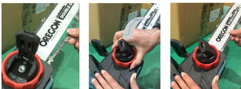
7. Obróć dźwignię zgodnie z ruchem wskazówek zegara, aż osłona koła łańcuchowego zostanie zabezpieczona, a następnie ustaw ją w pierwotnym położeniu.
