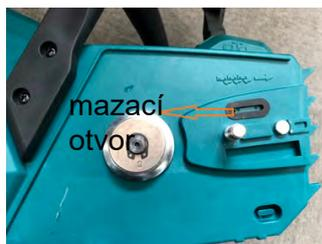
3. Vložte do zařízení baterii. Stiskněte hlavní provozní spínač a nechte nahromaděný prach a nečistoty odplavit pryč dalším uvolněním mazacího oleje.
