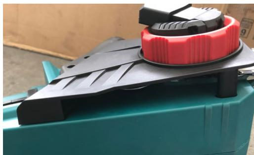
6. Obróć pokrętko napinające w prawo i sprawdź napięcie łańcucha; obracaj zgodnie z ruchem wskazówek zegara, aż do odpowiedniego momentu. Aby sprawdzić odpowiednie napięcie łańcucha piły, pociągnij łańcuch piły siłą około 1 kg, jeśli odległość między łańcuchem piły a prowadnicą wynosi 5-7 mm, jak pokazano poniżej, napięcie jest odpowiednie.
